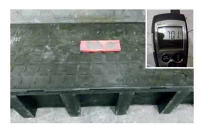
Brandprüfung mit glühendem Eisenklotz bei ca. 700°C, auf den Deckel gelegt.
